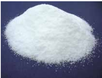
● Cera sintetica costituita da polietilene.
